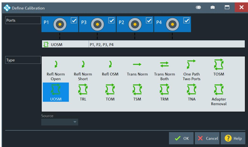
Figure3.1.1.10 設定校正 Port 數及校正法
