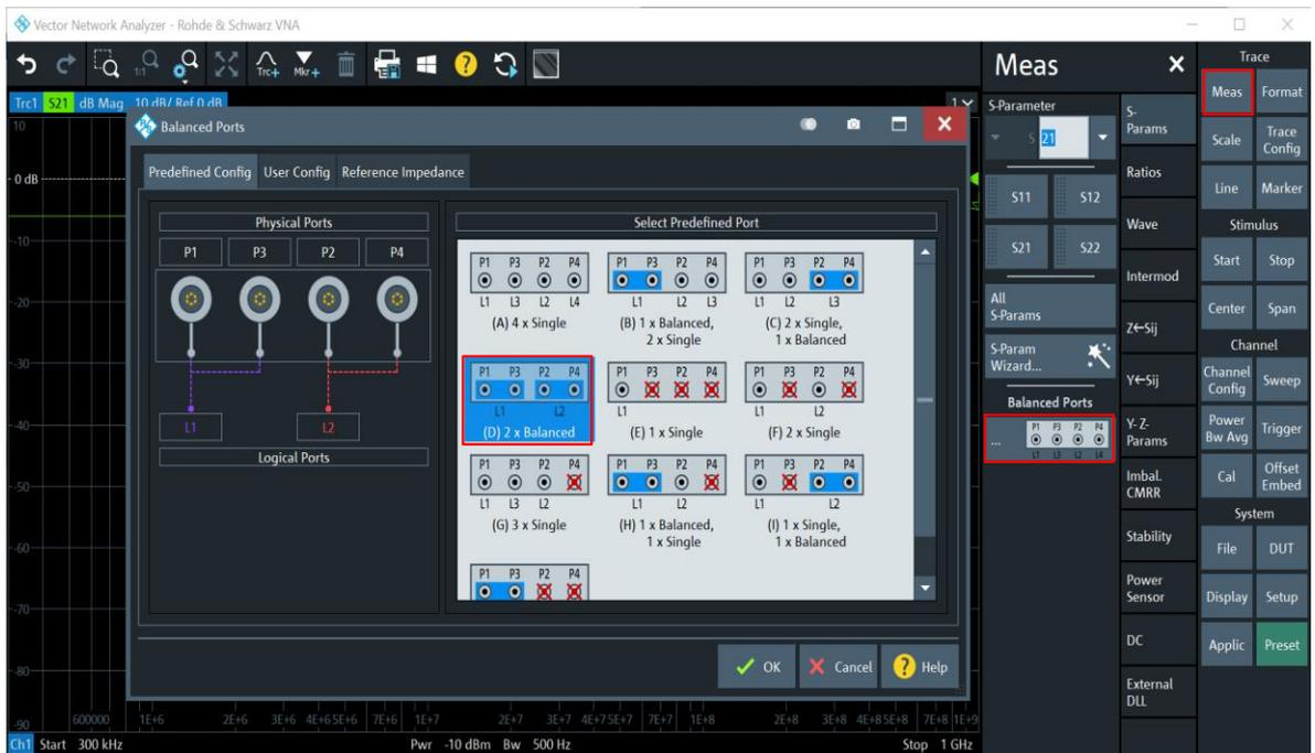
Figure3.1.1.6 設定 Balanced Port
