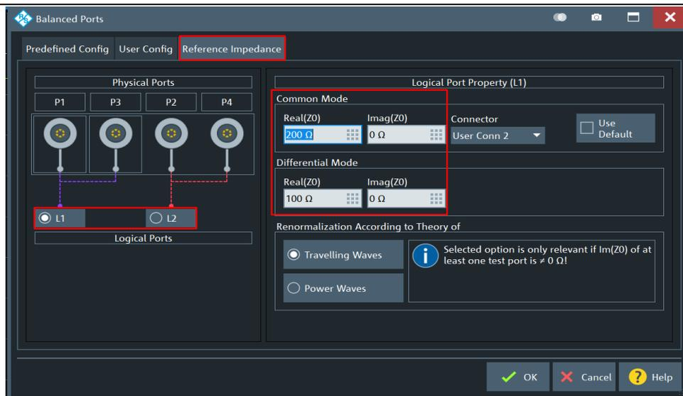
Figure3.4.2.8 設定 Balanced Port 阻抗值
