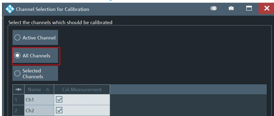
Figure3.3.1.8 執行合併校正
