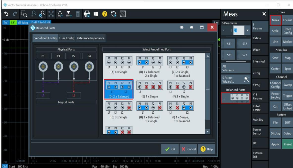
Figure3.4.2.7 設定 Balanced Port
