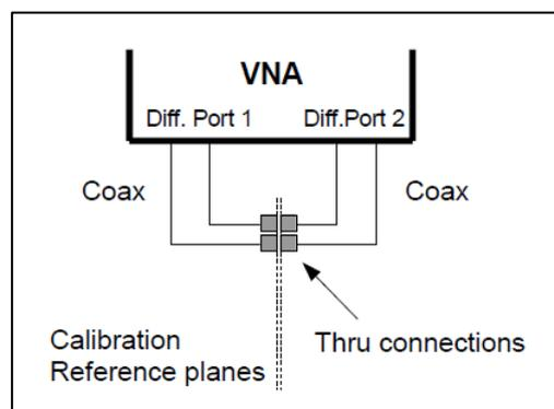
資料來源：Channel Components Requirements for 1000Base-T1 Link Segment Type A
