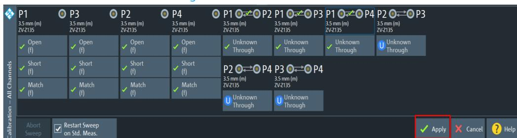
Figure3.3.1.11 點選 Apply 完成校正
