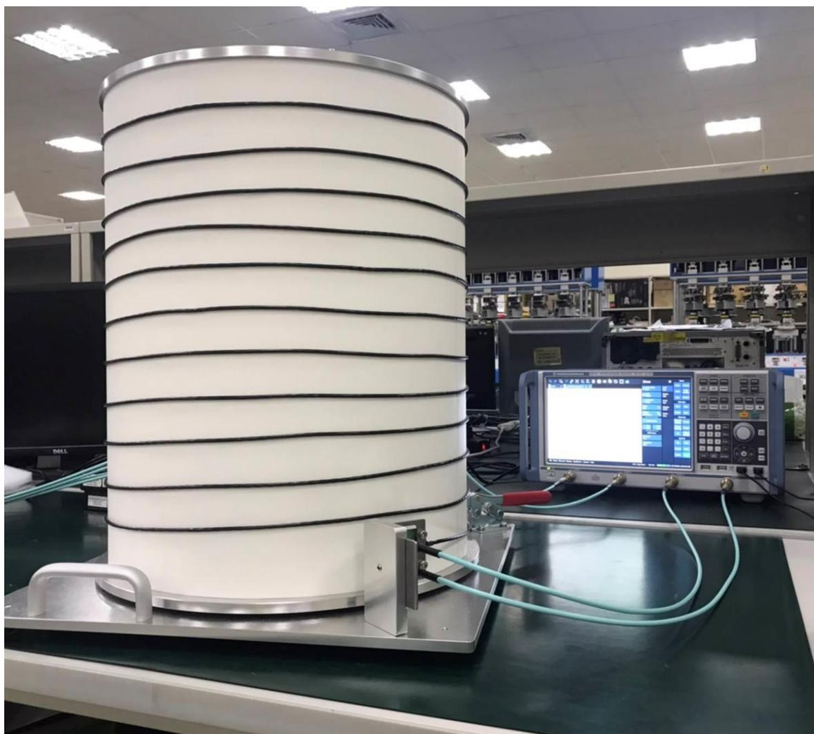
Figure 3.4 向量網路分析儀 ZNB 配合百佳泰 (Allion Labs) Conductive Drum 量測示意圖
