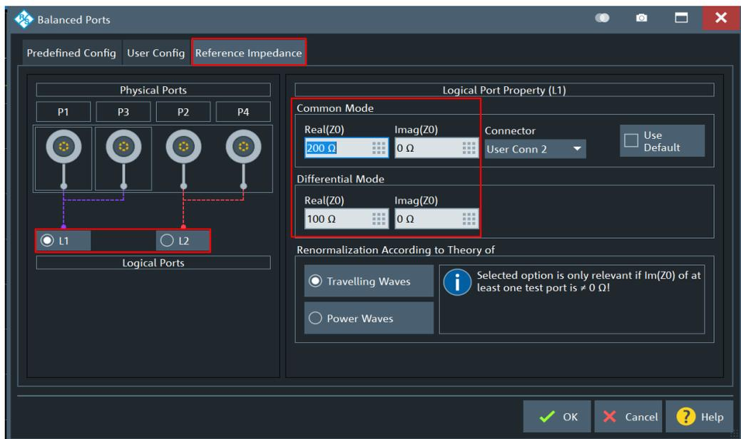
Figure3.1.1.7 設定 Balanced Port 阻抗值
