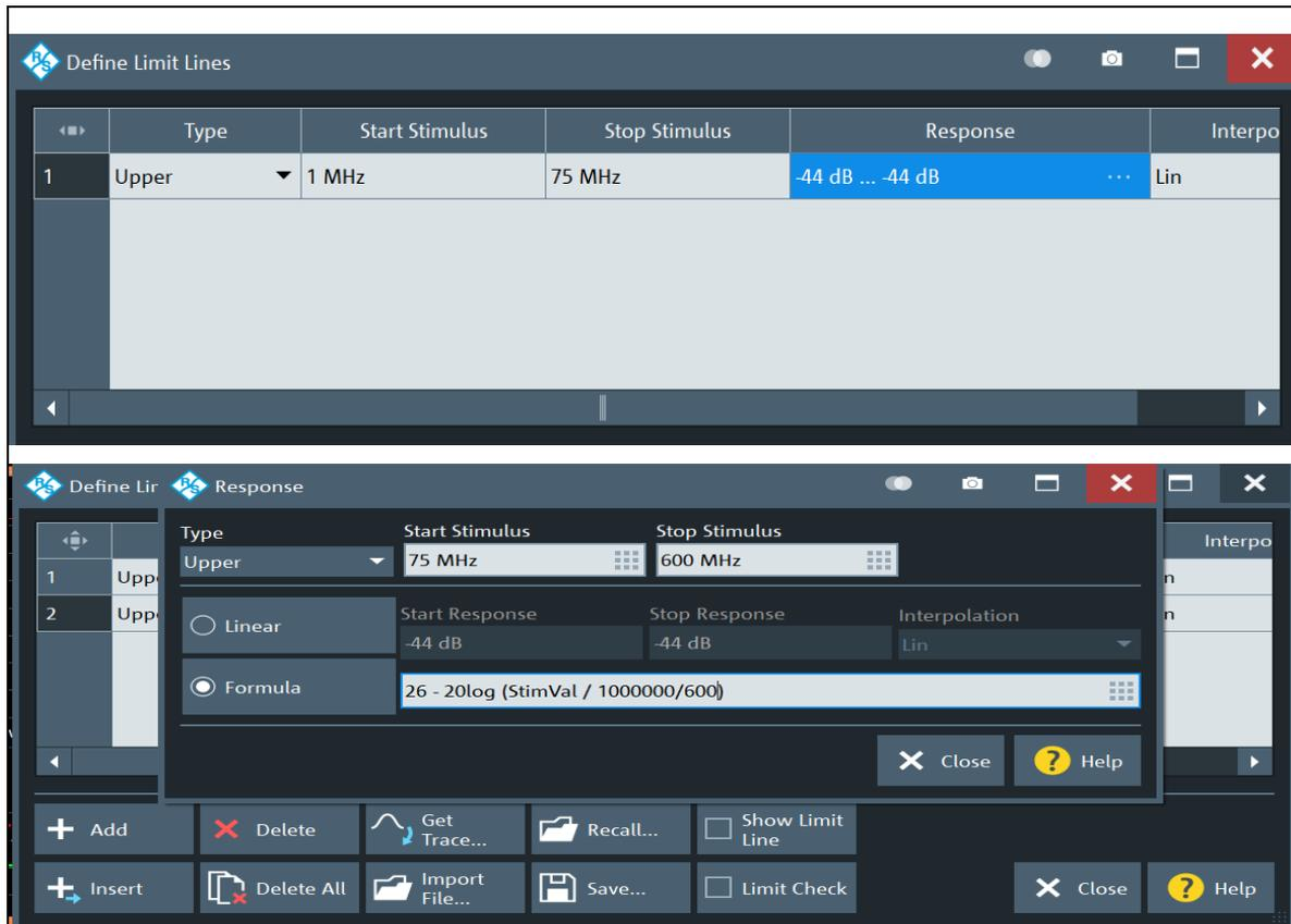
Figure3.1.2.2 RL 規格線設定
